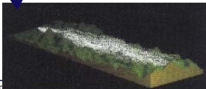
(正規分布型モデル: 排ガスの濃度分布を経験的に与える実用的な簡易的な手法。環境アセスメント&安全解析で広く活用される。)
