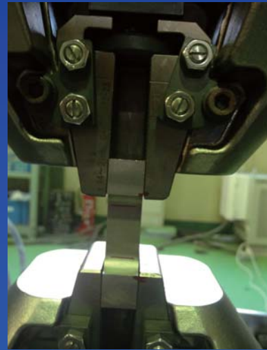
単結晶オーステナイト鋼を用いた 引張試験 in-situ超音波測定
