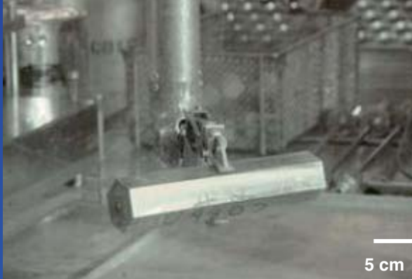
高速実験炉EBR-II反射材廃材を用いた超音波試験
