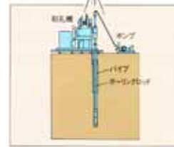
ボーリング調査
