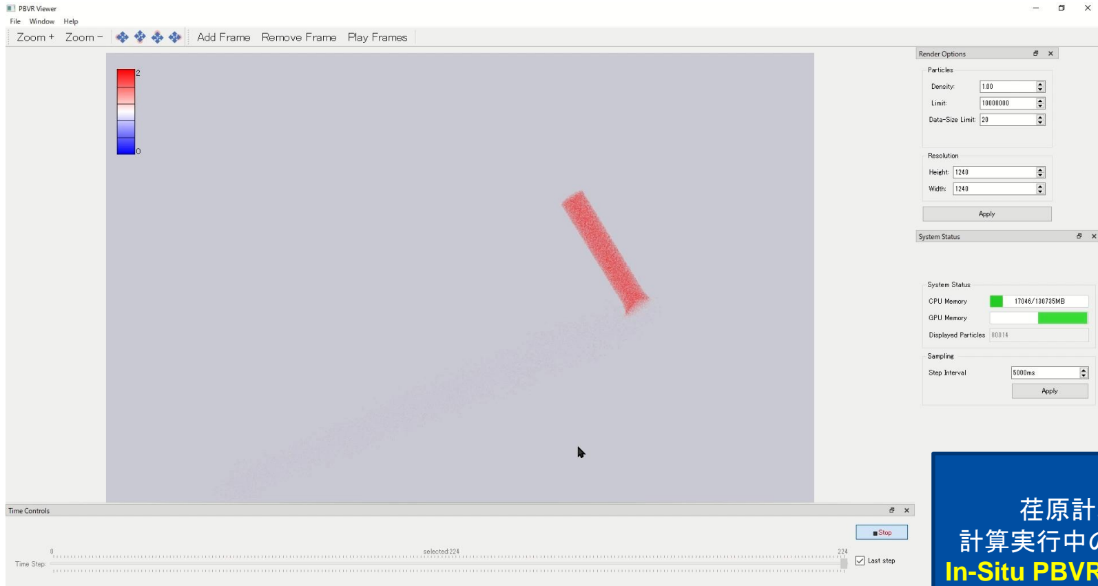
吸込み水槽のInSitu-PBVRによる可視化：流速の大きさに色付け
